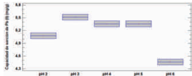
Figura 3. Efecto del pH sobre la capacidad de sorción de Pb (II) con biomasa de Zantedeschia aethiopica .
