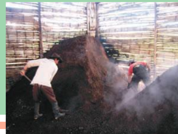
Foto B. Jaramillo 2006 Volteo a los ocho días donde se observa el desprendimiento de gases con aumento de temperatura.
