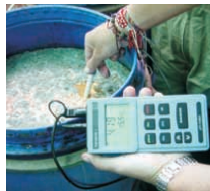
Foto 3. Medición de pH en aof líquido
