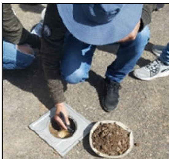
Figura 6. Ensayo de densidad con cono y arena
