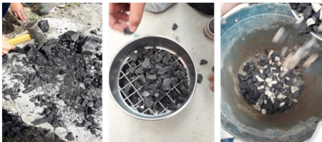
Fig 1. Adecuación del material, donde se evidencia la trituración y granulometría del carbón y la mezcla de los agregados usados en el proyecto.
