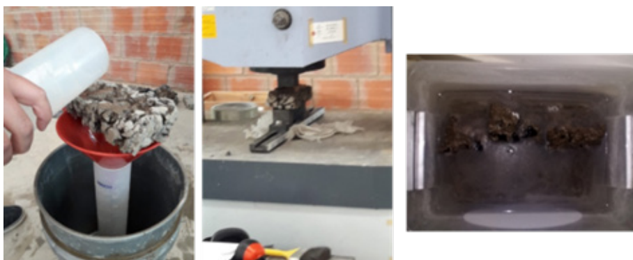
Fig 1. Medición de las propiedades de los adoquines: medición de permeabilidad, resistencia a la compresión y ataque químico con vinagre.
