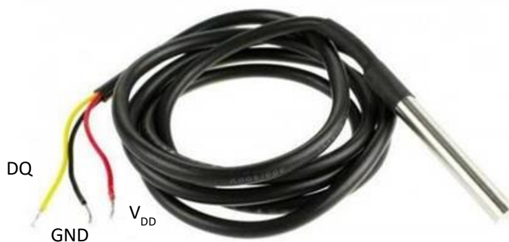
Figura 4. Sensor DS18B20 para medir temperatura. Fuente: Propia, 2019
