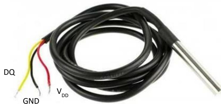
Figura 4. Sensor DS18B20 para medir temperatura. Fuente: Propia, 2019
