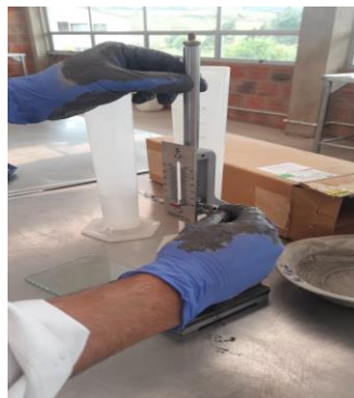
Figura 2. Muestra en el aparato de Vicat.
